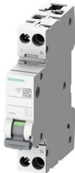
La curva C, soglia di intervento da 5 a 10 volte  $I_n$ , per applicazione di circuiti ohmico-induttivi con medie correnti di spunto. E' largamente usato negli impianti domestici.
